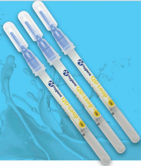
O QD-Loop é um dispositivo estéril que possibilita diluições precisas de forma prática e rápida. Sua alça vem anexada a um reservatório, onde guarda 1,0 ml de solução peptonada (QS1000) por meio da tecnologia patenteada Snap Valve.
