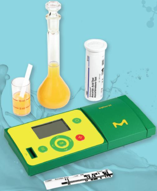
Teste rápido para detecção de fraudes em leite e soluções aquosas, através da reação de tiras reagentes e um aparelho refletômetro.
