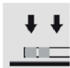
Cuidadosamente retire o excesso de líquido através da borda da tira com auxílio de uma toalha de papel absorvente.
